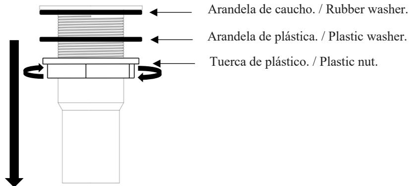
2. Introduzca el cuerpo de la válvula o de la rejilla con la arandela de caucho en el orificio del lavadero, lavaplatos o lavatraperero. / Insert the valve or the laundry drain with the rubber washer into the hole of the laundry sink, kitchen sink or mop sink.
