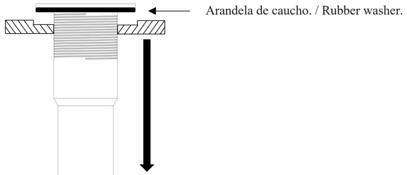
3. Por la parte inferior introduzca la arandela plástica y enrosque y ajuste la tuerca de plástico. / Insert the plastic washer from the bottom and screw and tighten the plastic nut.
